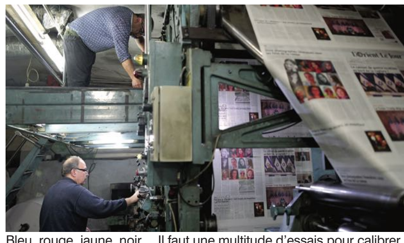
Bleu, rouge, jaune, noir... Il faut une multitude d'essais pour calibrer l'encre du journal, sans oublier la netteté des lettres. Un travail minutieux, au milieu de machines imposantes. Et voilà ! Le journal est prêt à être livré aux points de distribution puis aux abonnés.
